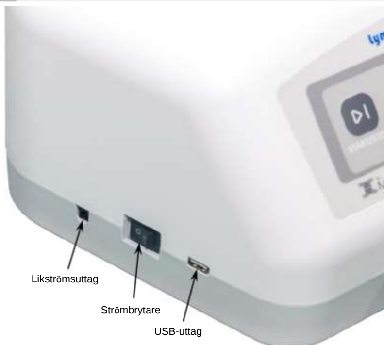
Figur 11 – USB-uttag, strömbrytare och likströmsuttag på konsolen
