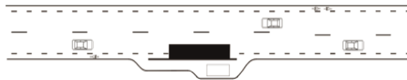
Figur 6b: Utformning av körbanehållplats i landsbygdsmiljö
